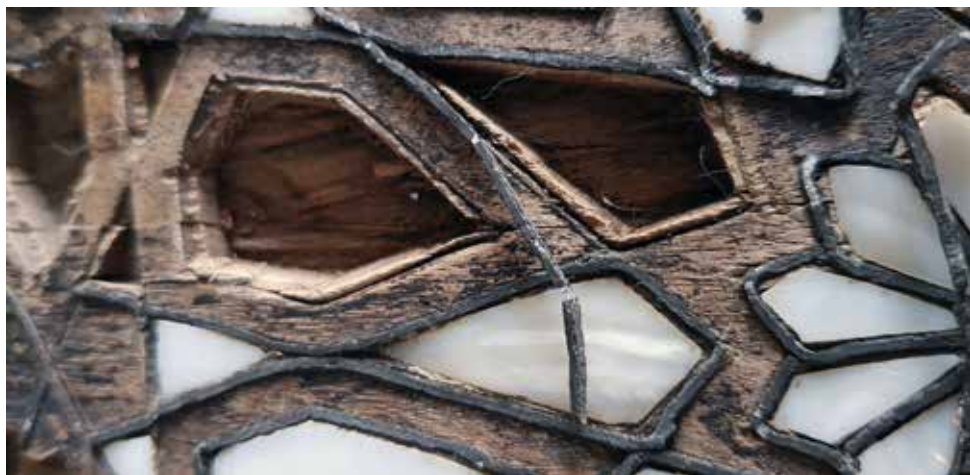
4. Fragment blatu stolika. Widoczne gniazda wycięte w drewnie w miejscach ubytku macicy perłowej oraz skorodowany drut cynowy. Stan przed konserwacją. Fot. J. Sęsiadek
