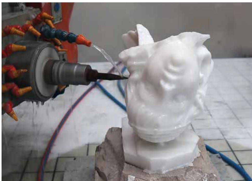
Proces frezowania rekonstrukcji głowy przez pięcioosiowe centrum obróbcze CNC. Fot. J. Latoń
