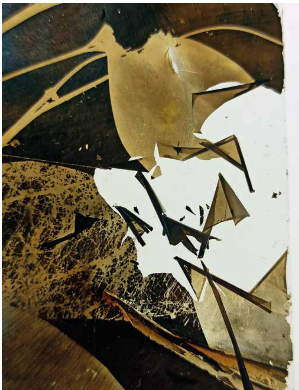
Fragment robocznego negatywu kolodionowego z odspojeniami warstwy obrazowej powstałymi po procesie przyspieszonego starzenia (zmiennie warunki wilgotnościowe i temperaturowe). Fotografia w świetle przechodzącym. Fot. K. Kudyba-Koszteyn
