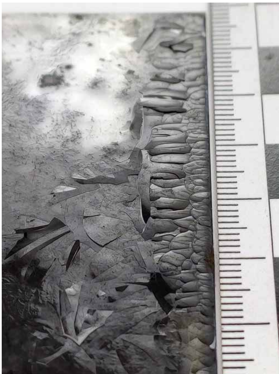
Fragment roboczego negatywu żelatynowo-srebrowego z odspojeniami warstwy obrazowej powstałymi po procesie przyspieszonego starzenia (zmienne warunki wilgotnościowe i temperaturowe).
