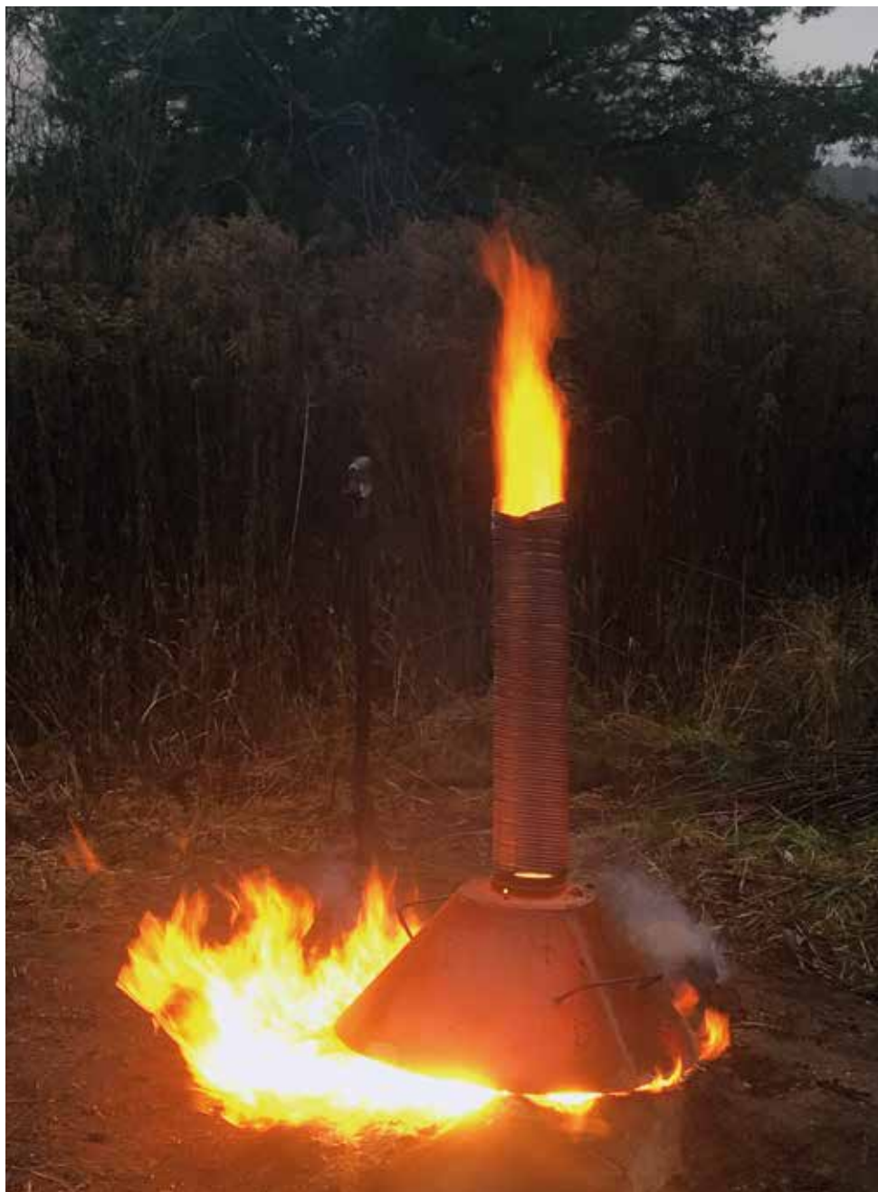
Odtworzenie średniowiecznej metody odlewania mosiężnych blach. Widoczny etap topienia miedzi w piecu tyglowym w celu sporządzenia odpowiedniego stopu. Fot. M. Tomyslak
