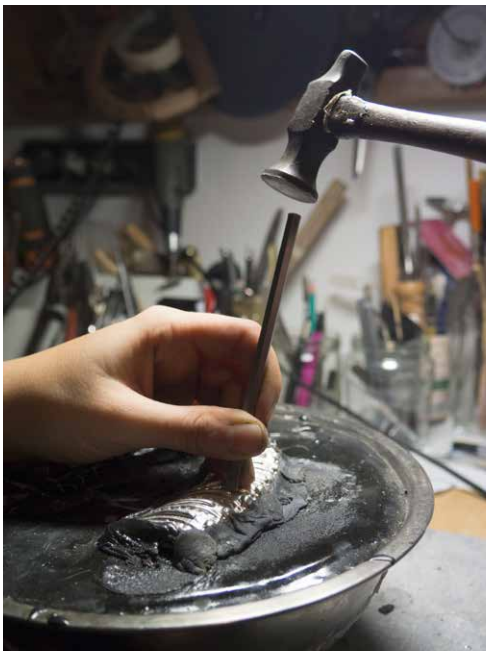
Opracowywanie rekonstrukcji fragmentu srebrnej repusowanej listwy. Fot. A. Pajka
