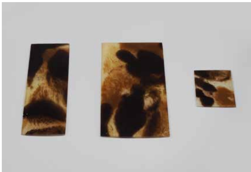
Płytki imitujące szylkret wykonane z żywicy epoksydowej Epidian 601 z utwardzaczem U-1. Fot. M. Janas
