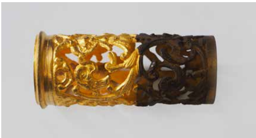
Złożony mosiężny element oczyszczony do połowy przy użyciu żelu na bazie EDTA i boraksu. Fot. M. Janas
