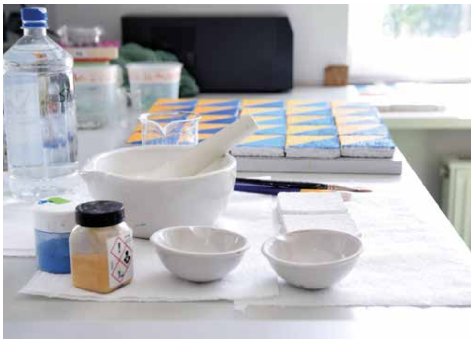
Przygotowanie modeli – wykonywanie warstw malarskich w technikach organicznych. Fot. K. Wójcicka
