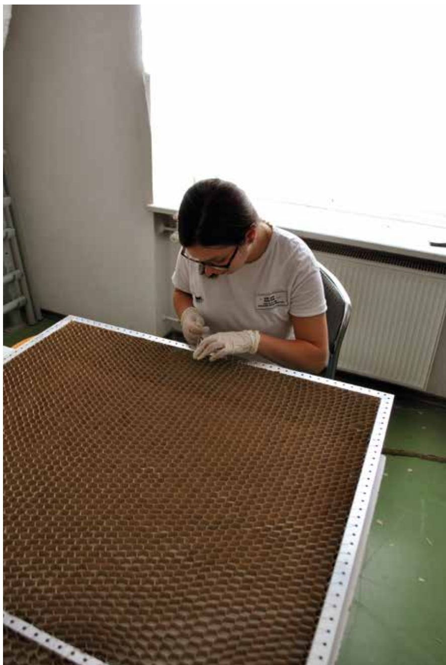
Budowa nowego podłoża przekładkowego – mocowanie rdzenia bloku ulowego do aluminiowego stelaża. Fot. A. Brud
