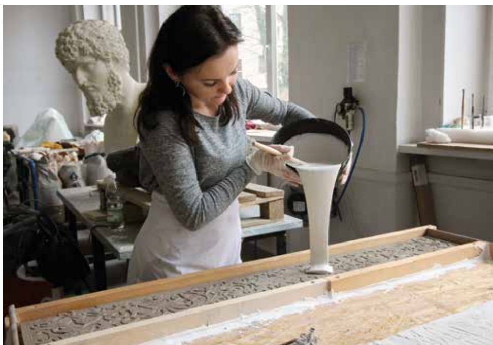
Wykonywanie formy silikonowej modelu górnej listwy bordiury wyrzeźbionej na podstawie rysunku Jana Nepomucena Danielskiego. Fot. K. Feć-Sfora
