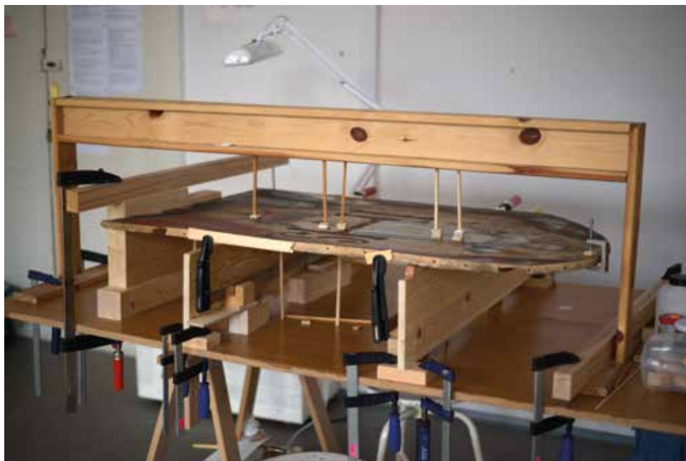
Adoracja Imienia Jezus, awers. Stan w trakcie konserwacji. Widoczny etap klejenia desek podobrazia drewnianego. Fot. G. Szalast-Dao Quy
