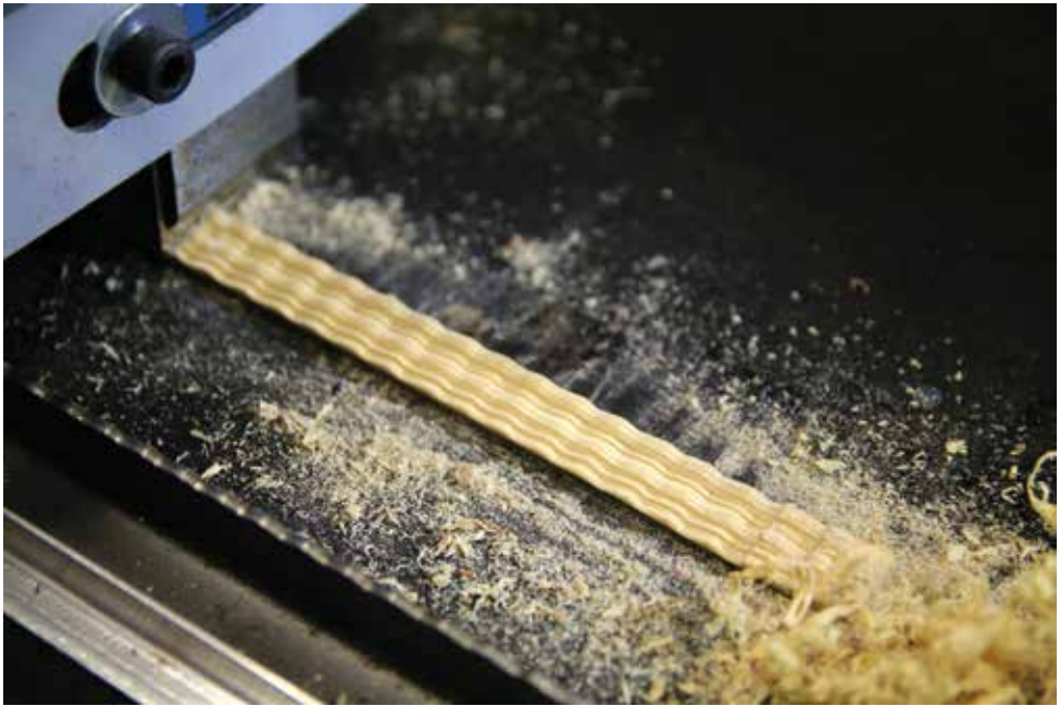
Urządzenie do wykonywania listew falistych i płomienistych w trakcie pracy. Fot. M. Malczewski 2018 r. The device for the production of wavy and ripple mouldings in operation. Photo by: M. Malczewski, 2018.
