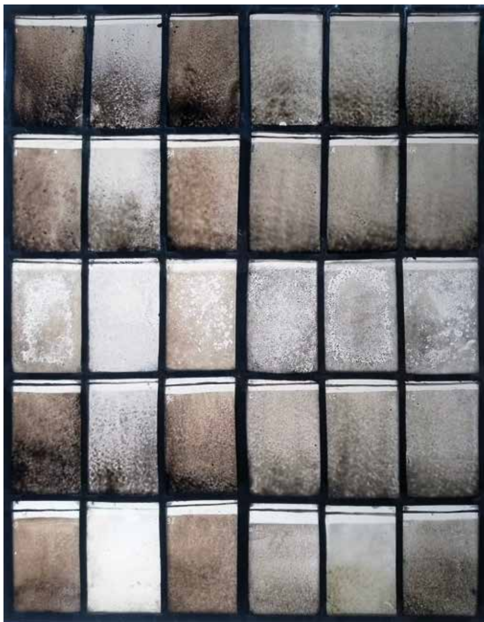
Próby malarskie z użyciem dwóch rodzajów farb (trzy kolumny po lewej Debitus Brun XVI eme , po lewej Reusche Colors Umber Brown Sepia), mediów (od góry woda, woda + guma arabska, olej lniany, ocet, olejek lawendowy), oraz trzech różnych wypalów. Fot. K. Korta
