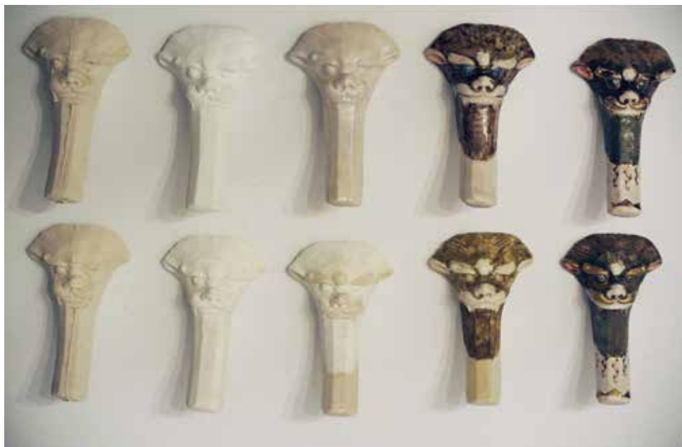
Zdjęcia nóżek z przedstawieniem lwa ShiShi. Proces tworzenia rekonstrukcji nóżki. Od lewej nóżka z szwami wypalona na biskwit, nóżka z tlenkiem cyny (ZnO), nóżka z szkliwem ołowiowym, nóżka z warstwą dekoracyjną (od góry farby naszkliwne, na dole angoba). Fot. A. Gurtat
