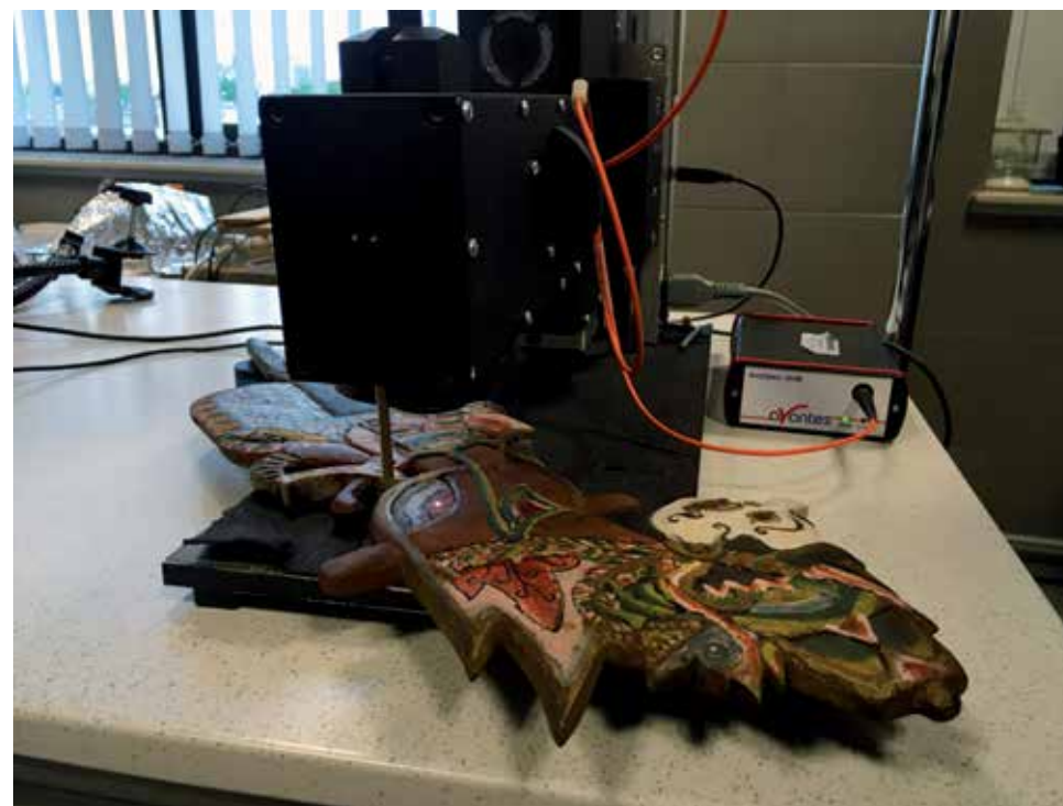
Badanie mikrofedometryczne światłotrwałości barwników organicznych na lalce Rawany (wyk. dr hab. T. Łojewski, Wydział Inżynierii Materiałowej i Ceramiki AGH w Krakowie), pozwalające na określenie podatności polichromii na proces fotodegradacji i zaplanowanie właściwej opieki profilaktycznej. Fot. P. Kralka
