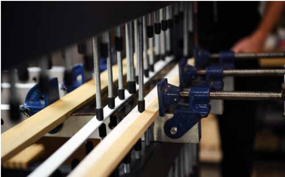
System klejenia podobrazia za pomocą stołu autorstwa Jeana-Alberta Glatigny'ego. Fot. J. Zwinczak
