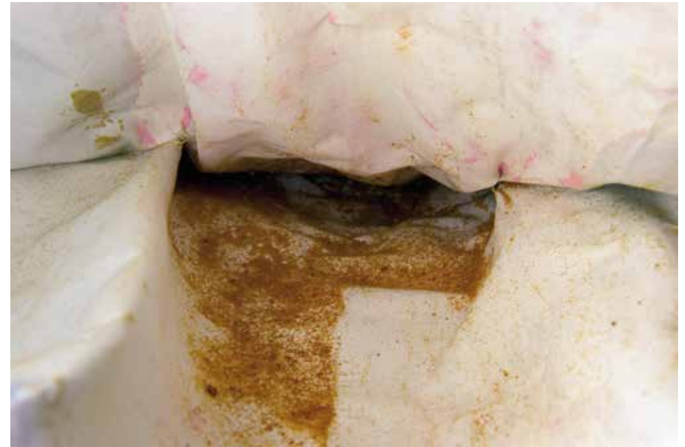
Wnętrze miękkiego elementu podczas usuwania drobinek zdegradowanej pianki poliuretanowej przyklejonych do tkaniny. Fot. O. Hanusek
