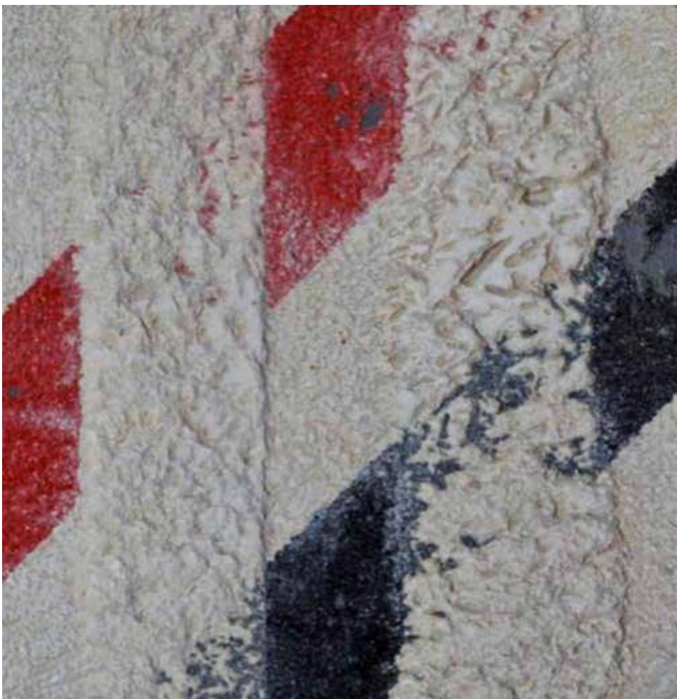
Wapień pińczowski czyszczony metodą strumieniowo-ścierną. Fot. S. Samolik
