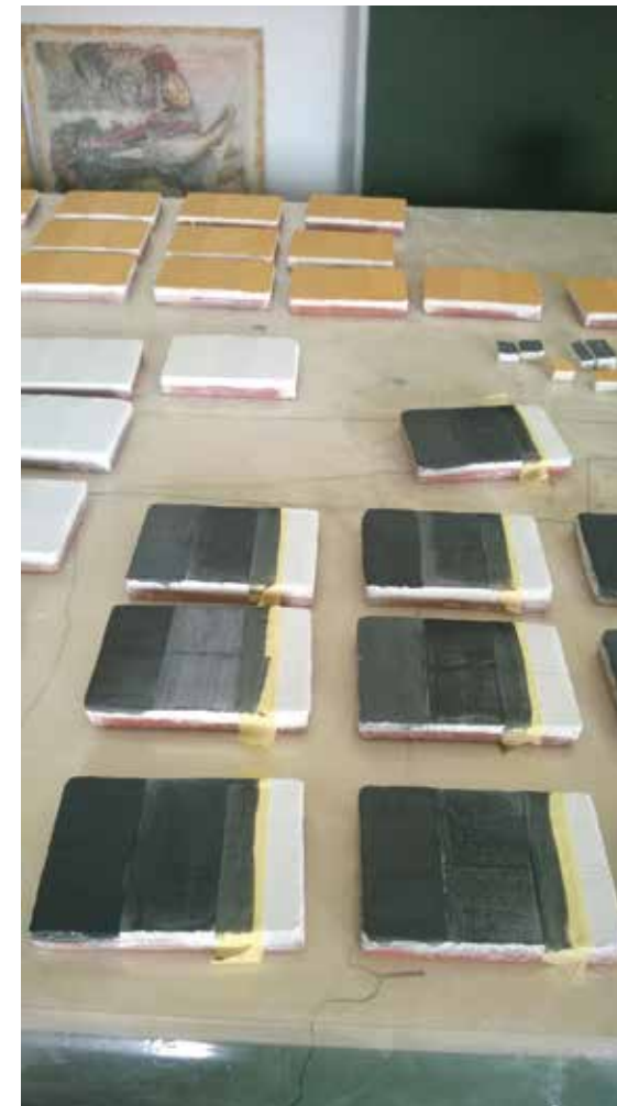
Modele malowideł ściennych w trakcie nakładania warstw malarzkich w trzech technikach-wapiennej, klejowej i technice kazeiny wapiennej.
